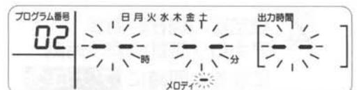
押したときにエラー音(ピピピピー)が鳴った場合は、未設定部分があります。液晶部分の点滅している部分を設定してください。
