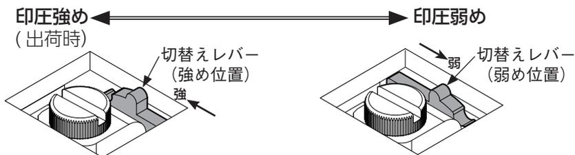
3. 印圧調整後、『ローレットネジ』を締めつけます。
