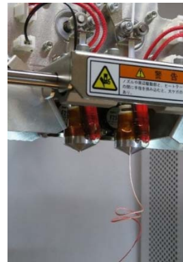
リオクリンフィラメントで ノズル内部を清掃
