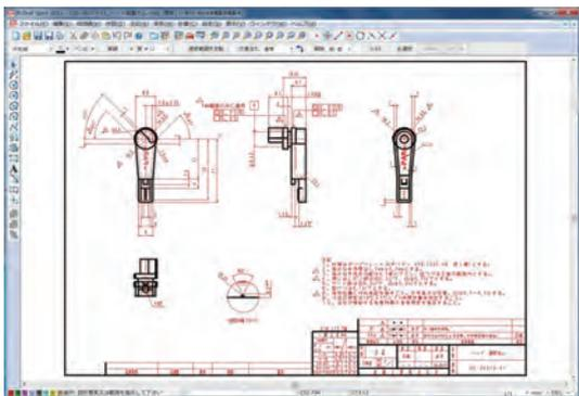
M-DrafSpiritは、「設計者の思考と手描き感覚を崩さない、より設計者に近い道具」をコンセプトに独自の操作性を形にしました。最大の特長は、ポップアップメニューによる作図スピードの向上と、視線移動を抑え疲れを軽減したことです。さらに、下書き線を利用して設計作業を進めることができるため、設計者の思考と手描き感覚のような作図作業性を実現しました。その他、パラメトリック機能、Microsoft WordやExcelなどのWindowsアプリケーション間とのオブジェクト貼り付けなど、実務設計で利用するあらゆる要素を備えています。
