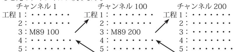
チャンネル 1 の工程 3 を実行するとチャンネル 100 の工程 1 にジャンプし、チャンネル 100 の工程 3 を実行すると再度サブルーチンジャンプ命令があるのでチャンネル 200 の工程 1 にジャンプし、工程 5 までのデータを終了するとチャンネル 100 の工程 4 を実行し、工程 5 が終了するとチャンネル 1 の工程 4 を実行し、工程 5 の全作業が終了します。ジャンプ命令は 5 重までループできます。
