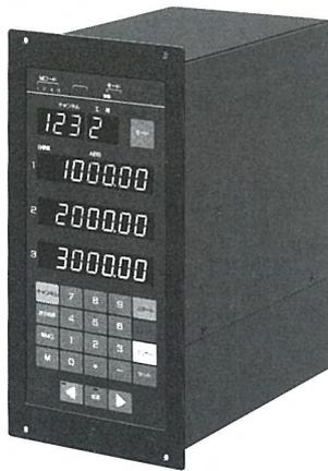
最大3軸までの同時位置決めを行ない、3軸分の位置決めデータは最大で1000チャンネル×1工程×3軸の3200データまで記憶可能。多軸を有するレベラー、パイラー、ロール成型機、フォーム印刷機など、専用ライン装置の各調整軸の自動位置決めに対応し、高精度・スピーディに処理できます。
