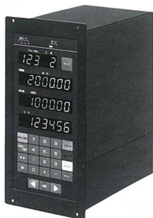
1軸多工程の位置決めを必要とする機械・装置に利用が可能。位置決めデータは最大1000チャンネル×99工程の最大3200データまで記憶可能。パンダー、プレスブレーキ、シャーリング、セットプレスなどの板金機械、ランニングソーなど各種切断機のバックゲージの自動位置決めにも、幅広く対応します。
