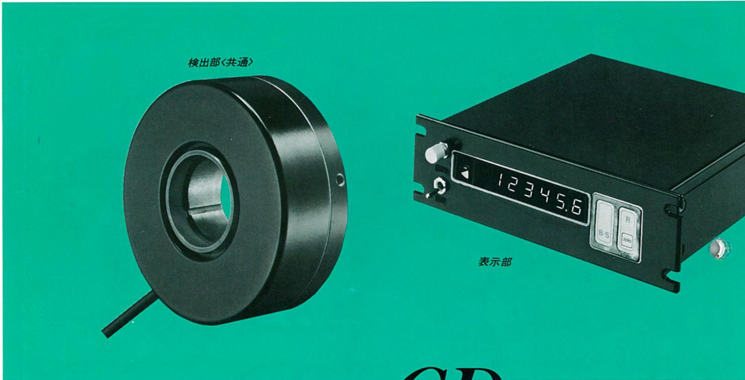
中型セパレートタイプは、回転軸内径35φ、ケーシング外径108φ、厚さ41mmの検出部と大型・小型共通の表示部で構成された最も汎用性のあるシリーズです。取付けはユニットタイプと同様、相方軸外径に合わせて取付カラー（標準装備）の内径を加工、3本の押さえネジで検出部全体を固定するだけですぐにご使用いただけます。
