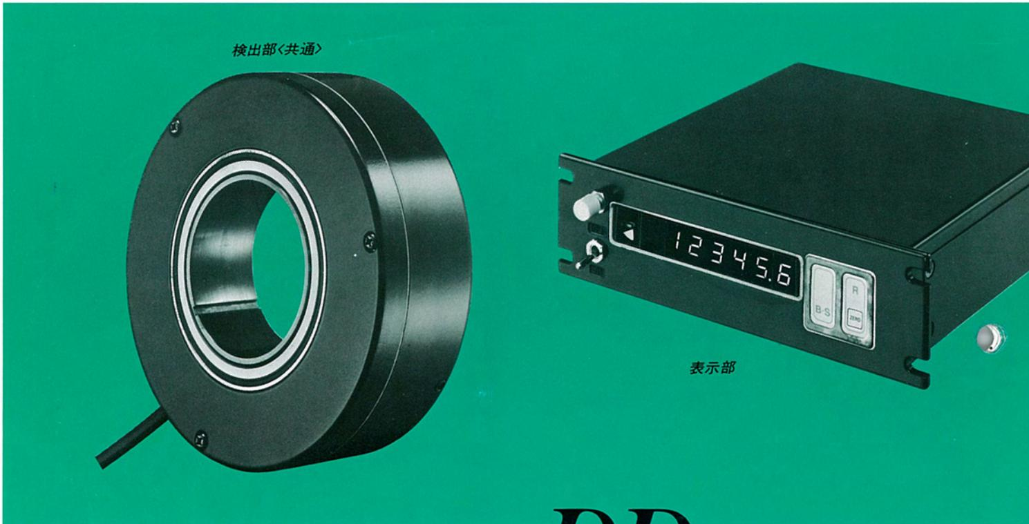
検出部と表示部が分離したセパレートタイプ。表示部を最も見易い位置にセットすることができます。検出部取付け位置が作業目線より高い所にあるとき、または機械装置の操作位置が離れているなどの場合に便利です。大型セパレートタイプは、検出部軸受内径が55φと大きく、相方軸外径30~49φ、55φに適合します。表示部は中型・小型セパレートタイプと共通。検出部と表示部を継ぐ接続コードの長さは2mです。また大型・中型・小型セパレートタイプはプリセット・外部出力・補助電源などのオプション装備が幅広く用意されています。
